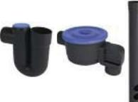
Spécialement conçu pour les récupérateurs d'eau de pluie Agriline. Comprend un filtre avec couvercle, un coude d'entrée, une arrivée d'eau à flux contrôlé et un siphon. Le filtre débarrasse l'eau des principales impuretés, grâce à une double grille de filtration fine (1,3 et 0,8 mm). Le siphon avec trappe de nettoyage fait office de barrière anti-odeur. Pour les toitures jusqu'à 220 m<sup>2</sup> (p. 30).
