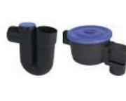
Spécialement conçu pour les récupérateurs d'eau de pluie Agriline. Comprend un filtre avec couvercle, un coude d'entrée, une arrivée d'eau à flux contrôlé et un siphon. Le filtre débarrasse l'eau des principales impuretés, grâce à une double grille de filtration fine (1,3 et 0,8 mm). Le siphon avec trappe de nettoyage fait office de barrière anti-odeur. Pour les toitures jusqu'à 220 m<sup>2</sup> (p. 30).
